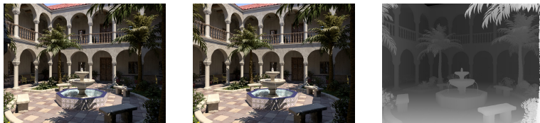
Рис. 7: Скорректированная стереопара и соответствующая ей карта смещений (disparity map)
