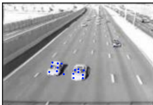
Рис. 38: Обнаруженные с помощью гессиана ключевые точки (a) и разделение ключевых точек по соответствующим объектам (b)
