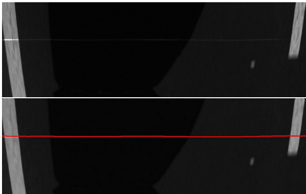
Рис. 8: Пример изображения с лазерным лучом в виде линии и детектирование этого луча
