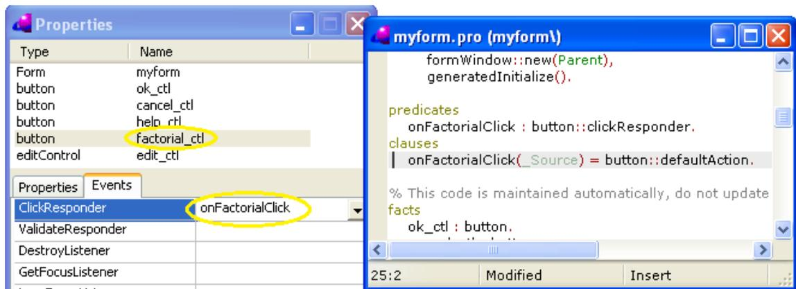
Рис. 5.22. Вкладка Events и прототип кода обработчика событий.
