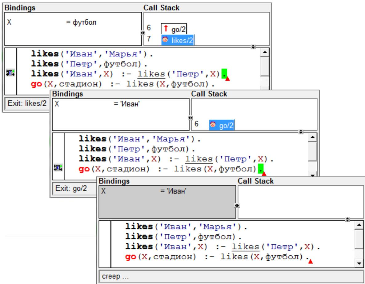
Рис. 3.15. Последовательность шагов трассировки вниз по дереву вывода.
