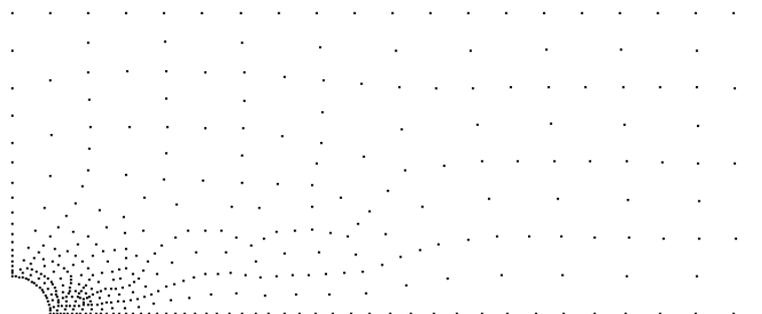
Рис. 6. Элементы PLANE183 и их узлы
