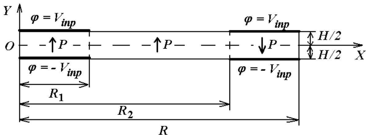
Рис. 2 Схема меридионального сечения пьезоэлектрического диска
