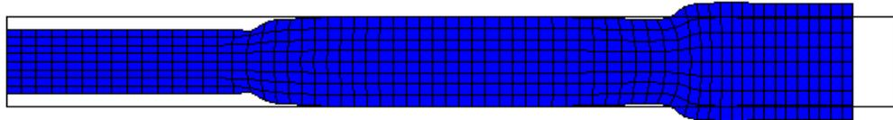
Рис. 9 Картина деформированной формы пьезоэлектрического диска
