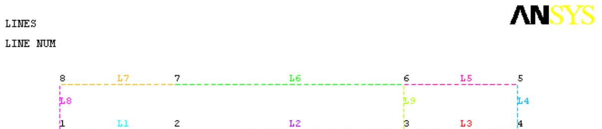
Рис. 4 Линии с заданным разбиением и опорные точки модели меридионального сечения диска
