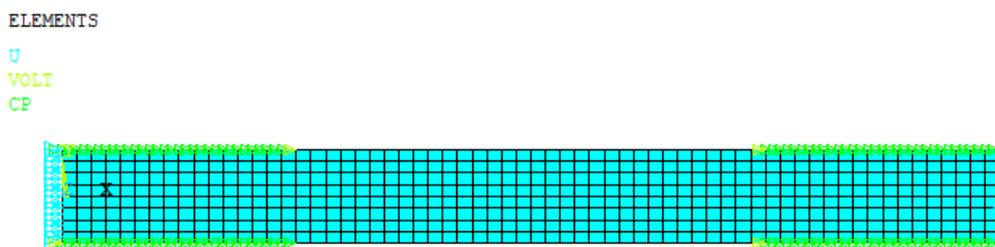
Рис. 8 Конечно-элементная сетка с граничными условиями
