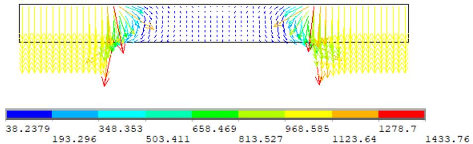
Рис. 14 Распределение вектора электрического поля  $E$
