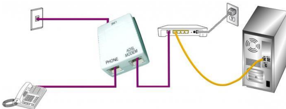
Рис. 2. Схема соединения абонентского оборудования ADSL
