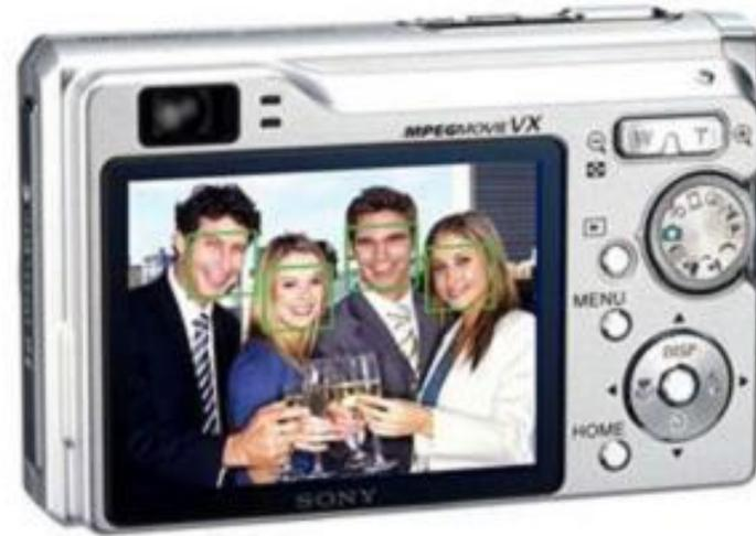
Первым известным алгоритмом, демонстрирующий силу ML в CV, стал алгоритм Viola-Jones (2001 г.) — надежный и быстрый (работа в режиме реального времени) детектор лиц.
