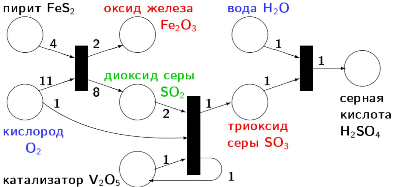
Технология производства серной кислоты.
