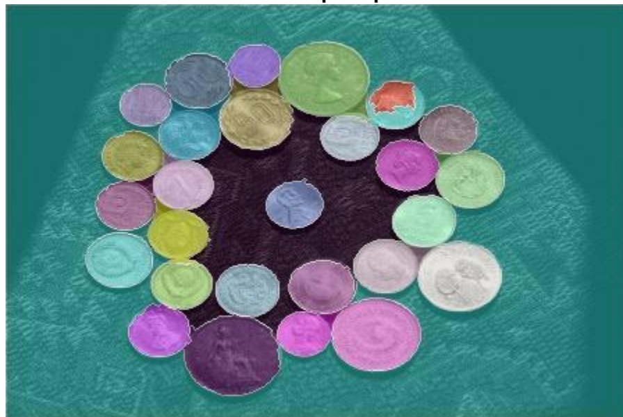
Изображение после сегментации алгоритмом WaterShed с использованием маркеров
