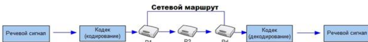
Рис. 1. Схема передачи оцифрованного речевого сигнала через IP-сеть
