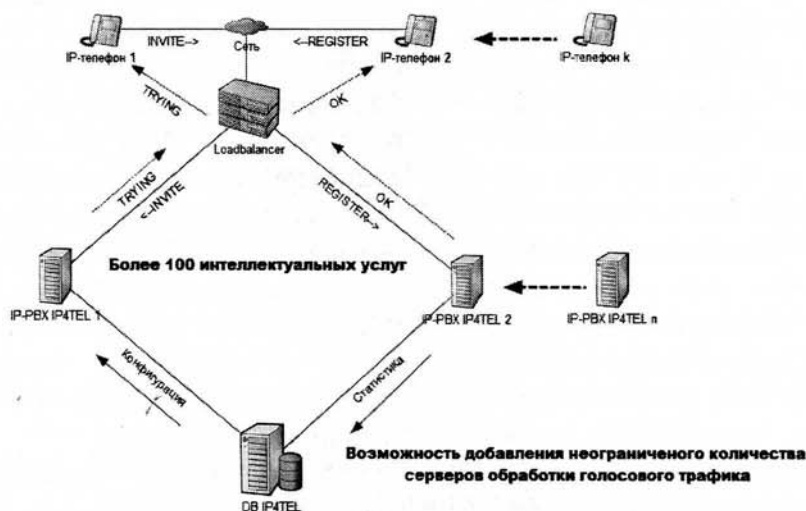
Рис. 1. Схема взаимодействия компонентов IP4TEL в составе системы IP-телефонии
