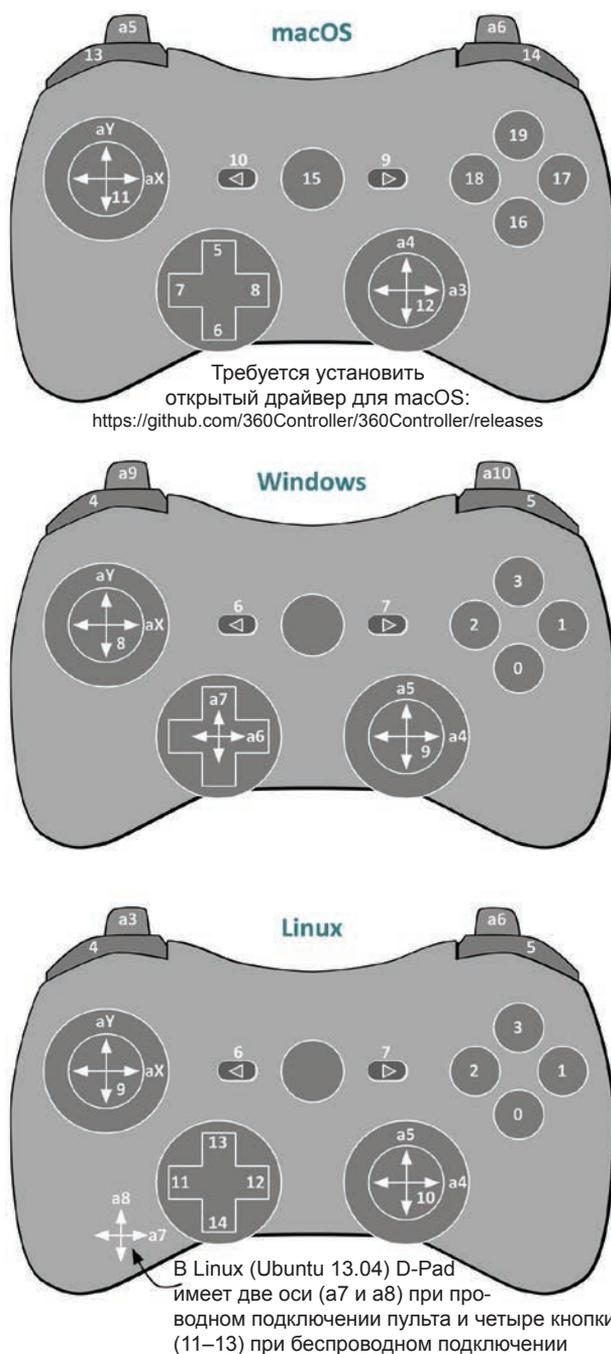
**Рис. Б.9.** Привязка кнопок на пульте Xbox в PC, macOS и Linux
