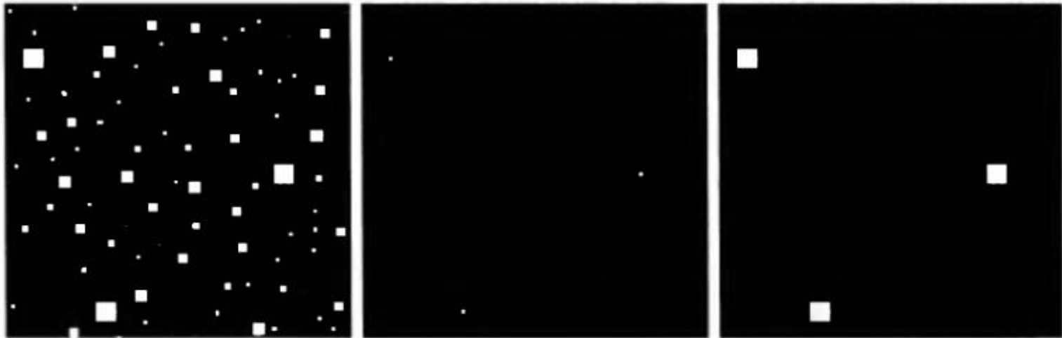
(а) Изображение, содержащее квадраты со сторонами 1, 3, 5, 7, 9 и 15 пикселей. (б) Результат эрозии изображения (а) по квадратному примитиву размерами 13 \times 13 пикселей, заполненному единицами. (в) Результат дилатации изображения (б) по тому же примитиву.
