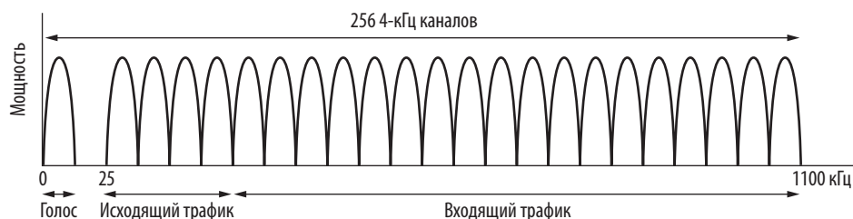
Илл. 2.29. Функционирование ADSL на основе дискретной многотональной модуляции
