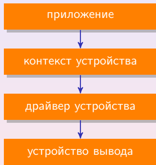
Рис. 1: структура взаимодействия приложения с устройством вывода
