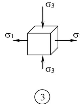
Плоское напряженное состояние возникает при деформации кручения, сдвига, среза, изгиба и при некоторых видах сложного сопротивления, в частности, плоское напряженное состояние имеет место в стенках сосудов небольшой толщины, нагруженных внутренним или наружным давлением (рисунок 1.4).
