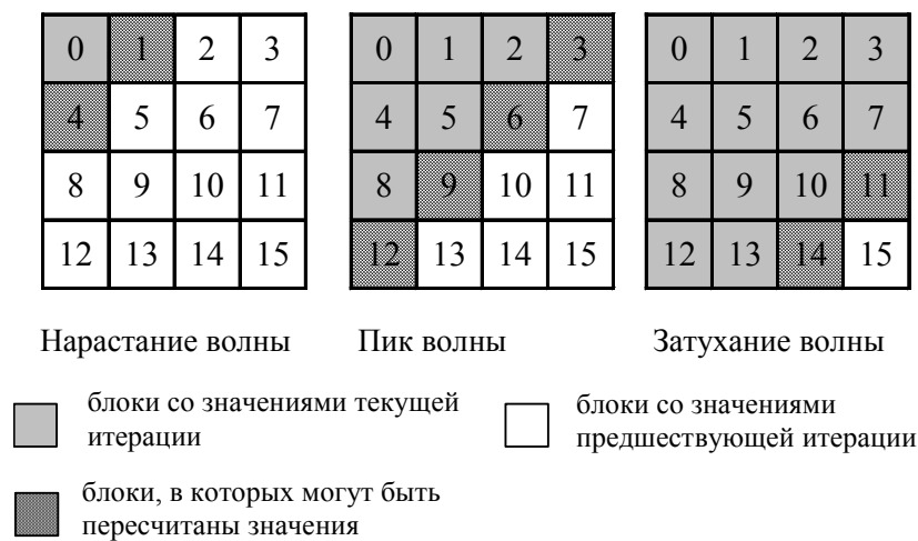
Рис. 12.13. Организация волны вычислений при блочной схеме разделения данных
